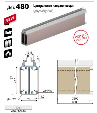
**МАТЕРИАЛЫ:** Профиль из анодированного алюминия; направляющая из нержавеющей стали AISI304 с покрытием из пээк.
