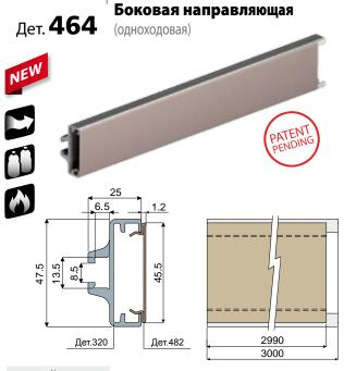
**МАТЕРИАЛЫ:** Профиль из анодированного алюминия; направляющая из нержавеющей стали AISI 304 с покрытием из пээк.
