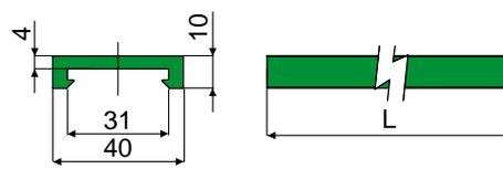
**МАТЕРИАЛЫ:** Профиль направляющей из полиэтилена.
