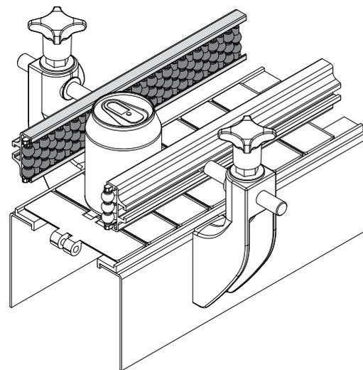
Дет. **474** **Боковая направляющая с шариковыми роликами**
